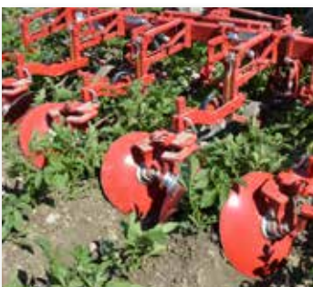
Front-Hackelement bis zu 150 cm mit Spurnanzeiger
