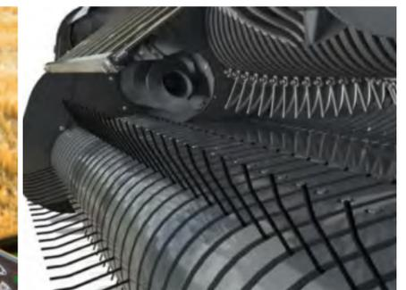
Highlights der High Performance Pick-Up der Fendt Quaderballenpressen sind unter anderem die fünf Zinkenreihen für eine maximale Futteraufnahme, Plastikabstreifer für einen reibungslosen Gutfluss sowie die vier Zentrierschnecken für eine optimale Gutzufuhr zum Raffer/Rotor.
