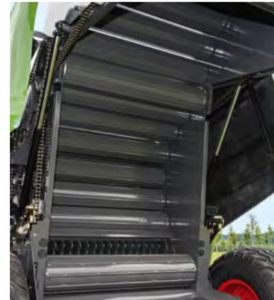
18 PowerGrip Walzen starten die Rotation zuverlässig und sorgen für gleichmäßige Verdichtung.
