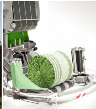
Super niedriger Schwerpunkt. Die ideale Balance zwischen Bodenfreiheit und niedrigst möglicher Konstruktion ermöglichen mit dem Rotana Combi sicherste Arbeit am Hang und die sanfteste Ballenablage am Markt.
