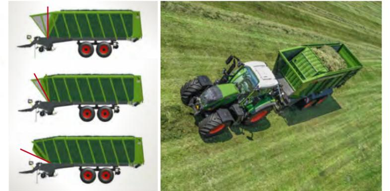
Die schwenkbare Multifunktionsstirnwand VarioFill zeichnet sich durch ihre Doppelfunktion aus. Zum einen wird Laderaum im vorderen Bereich des Wagens geschaffen und zum anderen sorgt die Stirnwand mit dem einstellbaren Vorverdichtungsdruck für maximal beladene Wagen bei gleichzeitiger Futterschonung.
