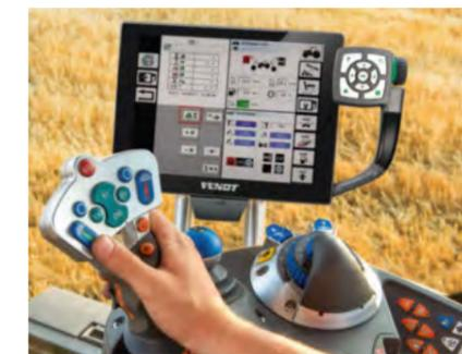
Startklar mit ISOBUS: Alle Fendt Quaderballenpressen sind serienmäßig ISOBUS-fähig. Damit kann die Presse auch direkt über das Varioterminal oder über ein Terminal eines ISOBUS-fähigen Traktors bedient werden.
