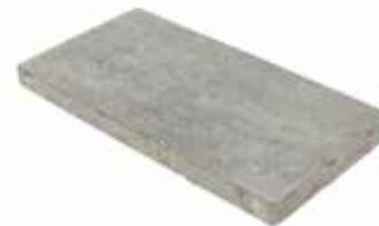
Satierte Betonplatte mit gebürsteter und zweimal imprägnierter Oberfläche mit leicht wolkenförmiger Nuancierung. Die verwendete Hydrophobierung reduziert die Wasseraufnahme im Stein. Lineare Kantenausbildung (ohne Fase). Verlegung immer mit einer mindestens 3 mm breiten Fuge und mit mindestens 2 % Gefälle.
