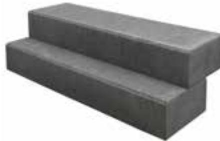
Oberfläche unbehandelt, maschinell hergestellte Stufen. Gleit- / Rutschwiderstand R13. Toleranz in allen Abmessungen max. 2 mm. Für Treppenanlagen geeignet.
