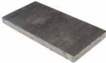
Satinierte Betonplatte mit gebürsteter und zweimal imprägnierter Oberfläche mit leicht wolkenförmiger Nuancierung. Die verwendete Hydrophobierung reduziert die Wasseraufnahme im Stein. Lineare Kantenausbildung (ohne Fase). Verlegung immer mit einer mindestens 3 mm breiten Fuge und mit mindestens 2% Gefälle.
