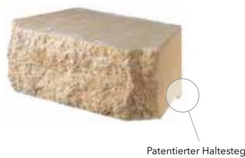
Ineinergreifende Elemente (patentierter Haltesteg). Bossierte Sichtseiten mit gebrochenen Steinkanten. Konische Steinform für problemlose Gestaltung von Innen- und Außenbögen. Für Mauern bis 90 cm Höhe ohne Bewehrung. Mit Bewehrung bis 5 m möglich.
