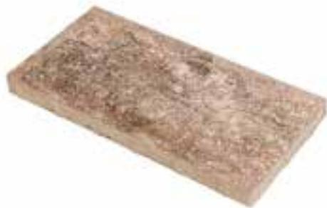
Satinierte Betonplatte mit gebürsteter und zweimal imprägnierter Oberfläche mit leicht wolkenförmiger Nuancierung. Die verwendete Hydrophobierung reduziert die Wasseraufnahme im Stein. Lineare Kantenausbildung (ohne Fase). Verlegung immer mit einer mindestens 3 mm breiten Fuge und mit mindestens 2 % Gefälle.
