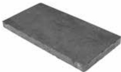
Satinierte Betonplatte mit gebürsteter und zweimal imprägnierter Oberfläche mit leicht wolkenförmiger Nuancierung. Die verwendete Hydrophobierung reduziert die Wasseraufnahme im Stein. Lineare Kantenausbildung (ohne Fase). Verlegung immer mit einer mindestens 3 mm breiten Fuge und mit mindestens 2 % Gefälle.
