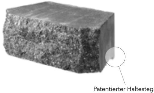
Ineinergreifende Elemente (patentierter Haltesteg). Bossierte Sichtseiten mit gebrochenen Steinkanten. Konische Steinform für problemlose Gestaltung von Innen- und Außenbögen. Für Mauern bis 90 cm Höhe ohne Bewehrung. Mit Bewehrung bis 5 m möglich.
