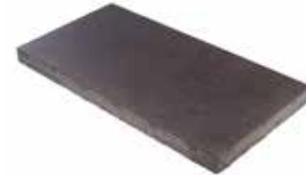
Satierte Betonplatte mit gebürsteter und zweimal imprägnierter Oberfläche mit leicht wolkenförmiger Nuancierung. Die verwendete Hydrophobierung reduziert die Wasseraufnahme im Stein. Lineare Kantenausbildung (ohne Fase). Verlegung immer mit einer mindestens 3 mm breiten Fuge und mit mindestens 2 % Gefälle.
