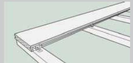
Der Clip verfügt über ein vorgefertigtes Bohrloch. Bohren Sie durch dieses hindurch und befestigen Sie den Clip mit einer Schraube an der Mitte der Unterkonstruktion.
