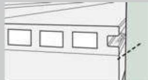
Bei der letzten Diele gehen Sie wie im ersten Schritt beschrieben vor – Aufnahmebohrungen im 45°-Winkel zwischen die Nutwangen setzen und festschrauben.
