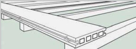
Zu Beginn setzen Sie die erste Diele, beginnen Sie dabei außen auf Anfangsposition der Unterkonstruktion. Aufnahmebohrungen sollten in einem 45°-Winkel zwischen die Nutwangen der Diele zentral in die Unterkonstruktion gesetzt werden. Prüfen Sie, ob das empfohlene Gefälle von 1 % in Längsrichtung eingehalten wurde. Nun verschrauben Sie die Diele.
