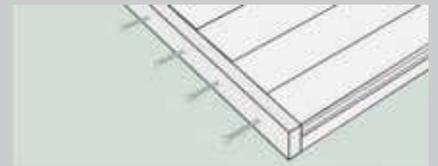
Wenn Sie ein Abschlussprofil montieren wollen, sollten Sie zuerst die Vorbohrung durch das Profil hindurch in die Seite der Diele oder der Unterkonstruktion setzen. So können Sie das Profil anschließend bündig verschrauben.
