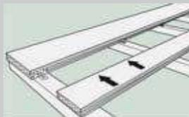
Anschließend setzen Sie die zweite Diele an und schieben diese mit sanftem Druck gegen die Clips. Achten Sie darauf, dass alle Clips in die Seitennut der nächsten Diele passen.
