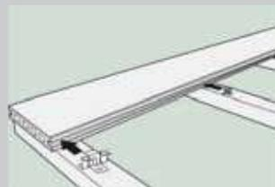
Setzen Sie die Clips in die Seitennut der Diele ein.
