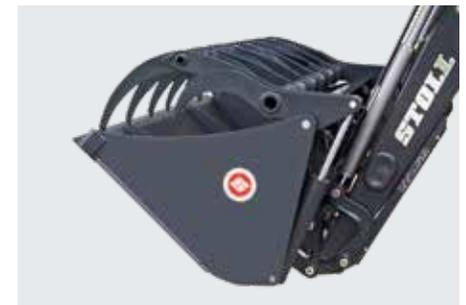
**2** Das Werkzeug ankippen – die Verriegelung rastet automatisch ein
