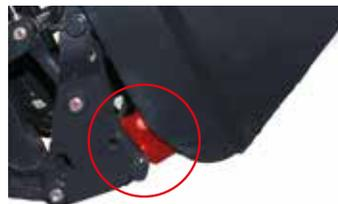
**14 Grad Adapter** – dank des verbesserten Ankippwinkels bleibt alles in der Schaufel
