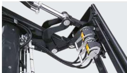
Für eine noch schnellere Verbindung der hydraulischen Leitungen gibt es den Werkzeug-Fix für den Werkzeuganbau.
