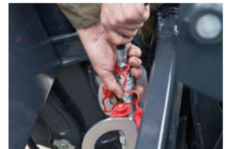
**3** Kuppeln der hydraulischen Verbindung
