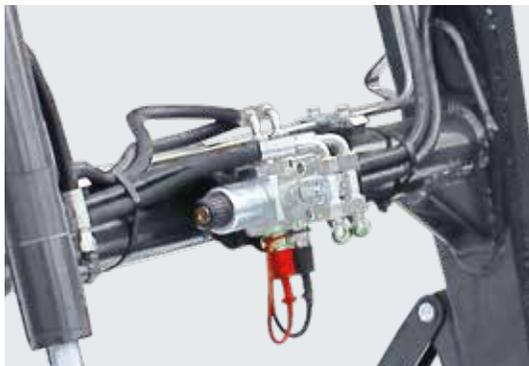
Für das einfache Bedienen hydraulischer Werkzeuge wie Löffelbagger, Obergreifer, Schaufelzange, Greifgabel oder Rückezange.
