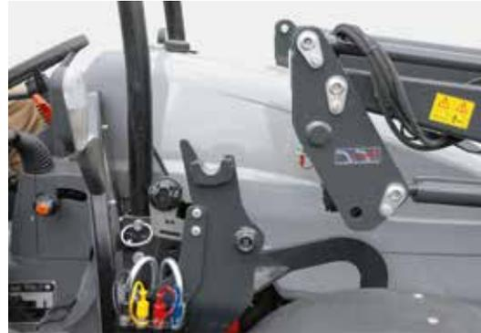
Mit wenigen Handgriffen wird der Frontlader abgestellt. Per Steuergerät wird die Anbausäule aus dem Anbauteil herausgeschwenkt, die Abstellstützen herabgelassen und die Hydraulik abgekoppelt.
