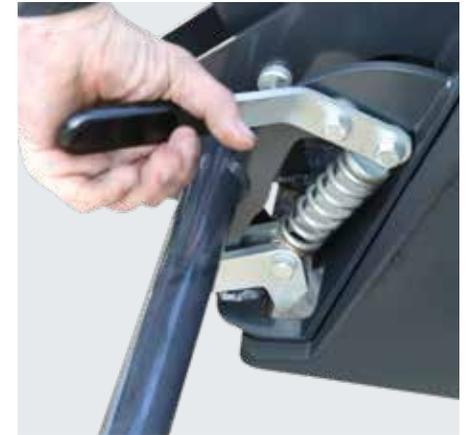
**3** Beidseitig zu bedienende Werkzeugverriegelung.
