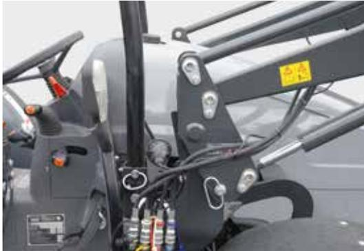
Lader und Traktor werden mit dem speziellen Einschwenksystem sicher miteinander verbunden.
