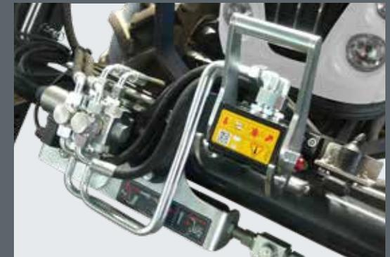
Werkzeug-Fix kpl. zum einfachen koppeln von hydraulischen Werkzeugen.
