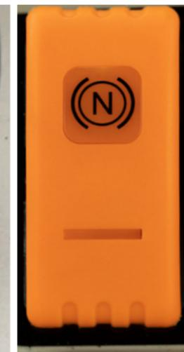
Durch Aktivieren der Funktion **Bremsen auf Neutral** wird parallel die Kupplung aktiviert, sobald das Bremspedal betätigt wird.
