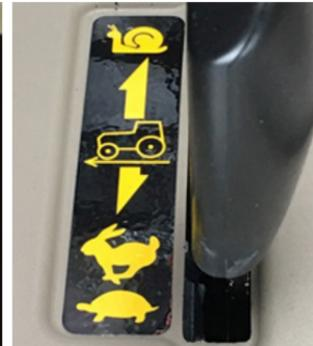
Die **optionalen Kriechgänge** ermöglichen bei Arbeiten, die besonders niedrige Geschwindigkeiten erfordern, eine präzise Anpassung der Vorwärtsgeschwindigkeit bis zu niedrigen Geschwindigkeiten von 100 m/h.
