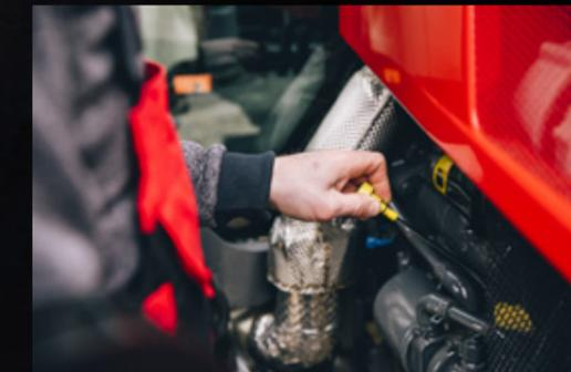
Das Design der Vorderachse und der schmalen Motorhaube erleichtert den Zugang zum Ölpeilstab und zum Ölfilter.
