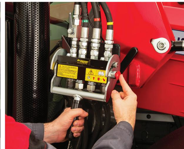
Hydraulische und elektrische Verbindungen trennen
