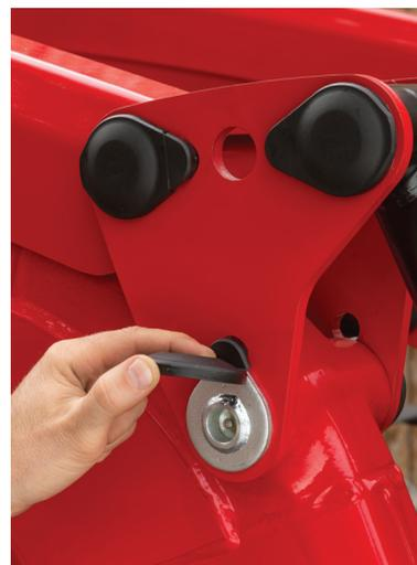
**Einfache Wartung** – Nach außen weisende Schmierstellen, bequem zugänglich und mit Schutzabdeckung
