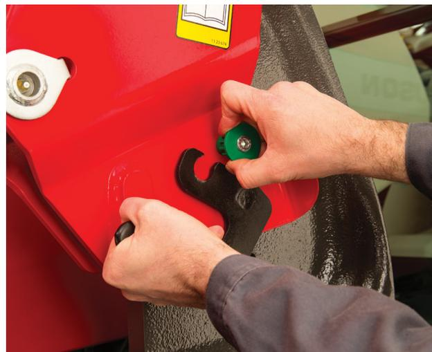
Arretierung lösen, dann Bolzen drehen und ziehen
