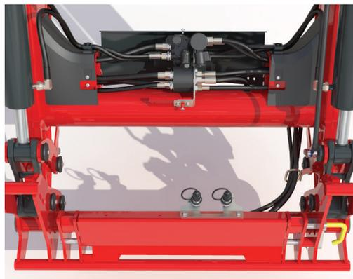
Das Querrohr nimmt Hydraulikkomponenten auf und sorgt für Stabilität, ohne jegliche Beeinträchtigung der Sicht
