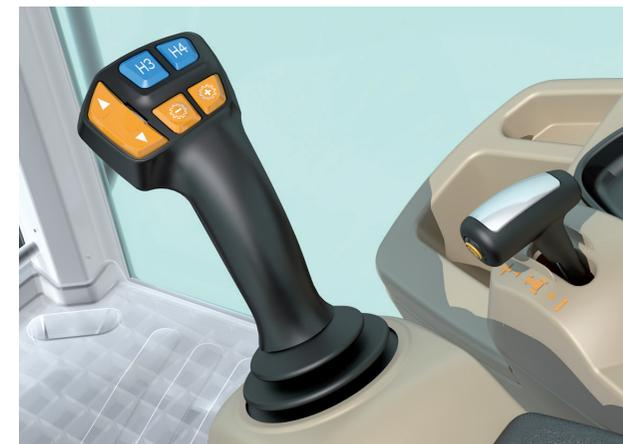
Kabinenoption Efficient mit elektrischem Multifunktions-Joystick und Armlehne
