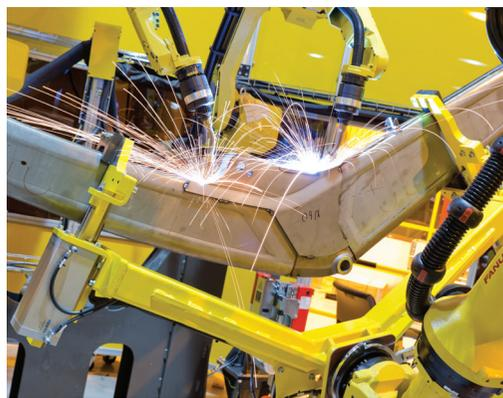
Roboter-geschweißter Rahmen garantiert Präzision und Stabilität
