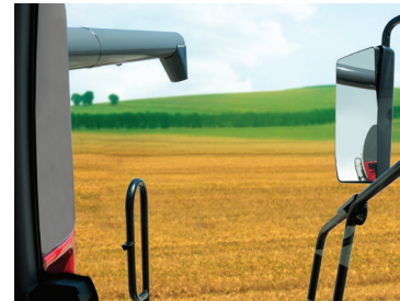
Direkter Blick auf die Entleerungsschnecke im Betrieb
