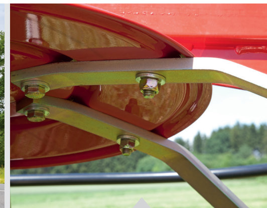
Breite Kontaktfläche für optimale Kraftübertragung
