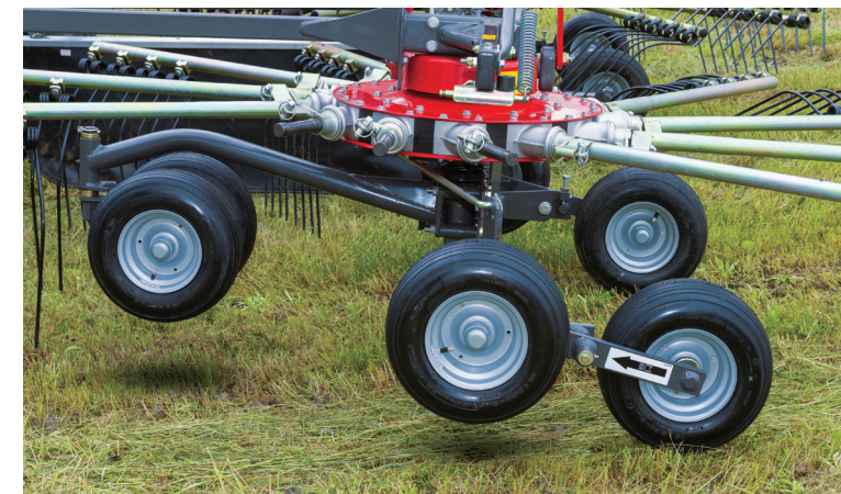
Patentierte, komplett kardanische Kreiselaufhängung
