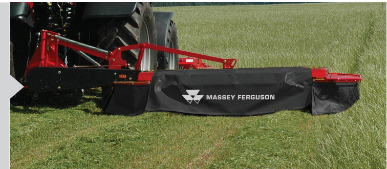
Heckanbau- Trommelmähwerk mit Seitenaufhängung
