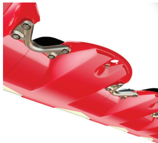
Stromlinienförmiger Messerbalken (Unterseite)
