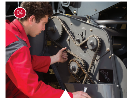
04 Überprüfen der Pickup-Kettenspannungen.
