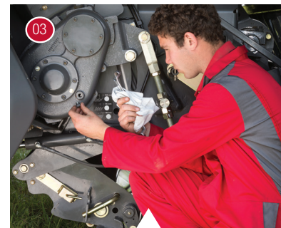
03 Überprüfen des Ölstands des Schneidwerkgetriebes.
