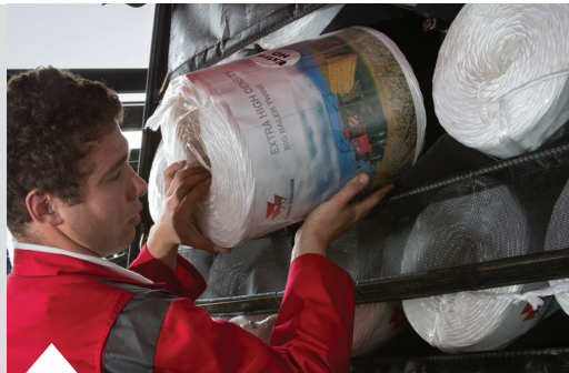
Einfache Befüllung der „Easy-Fill“-Garnkästen.
