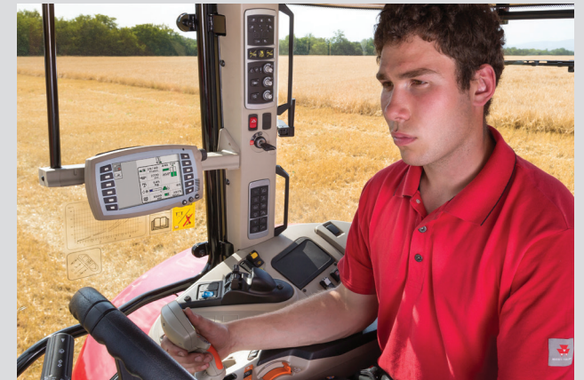
Steuerung der Ballenpresse über das ISO-VT-Terminal des Traktors.
