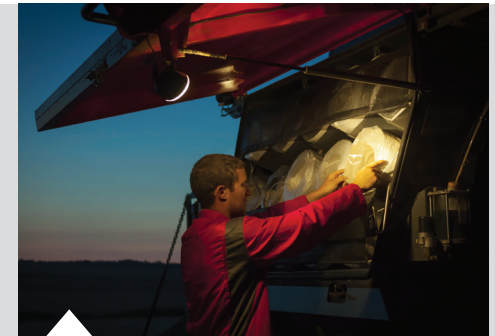
Die Garnkasten-Beleuchtung erlaubt auch bei Dunkelheit ein problemloses Befüllen der Garnkästen.
