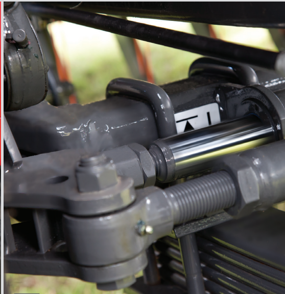
Hydraulische Lenksperre der Hinterachse.
