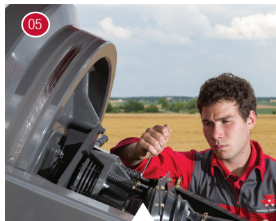
05 Einstellen der Schwungrad-Rutschkupplung.
