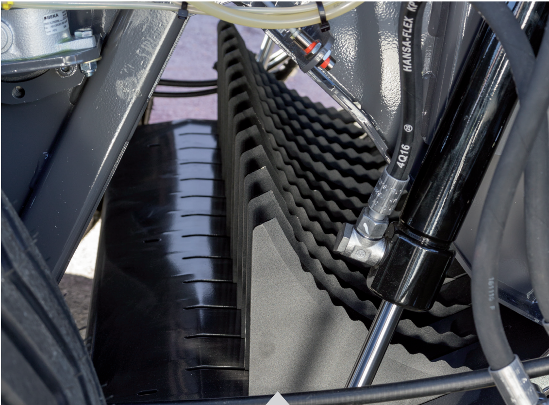
Das Schneidwerk Xtracut 13 verfügt über eine Schnittlänge von 90 mm.
