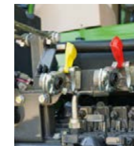
Die Zweikreisdruckluftbremse wirkt auch auf den Anhänger, wenn die Parkbremse eingelegt ist.
