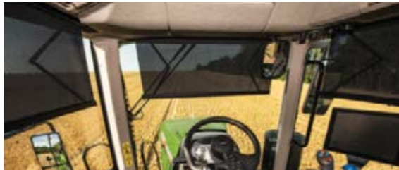
■ Die Sonnenrollos an allen Seiten schützen den Fahrer vor Blendung und verschwinden sauber im Dachhimmel.
