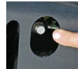
□ Der Druck zur Laufbandvorspannung kann bequem von der Seite per Anschluss angepasst werden.
