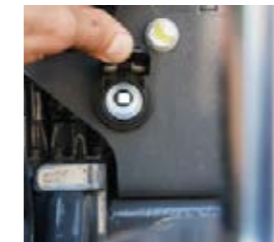
■ Der 12 V Anschluss am Heck der Maschine versorgt externe Spannungsabnehmer.
