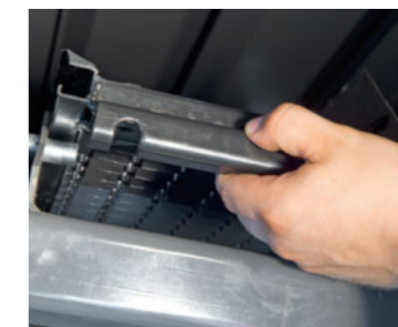
Ausbau der Siebe
