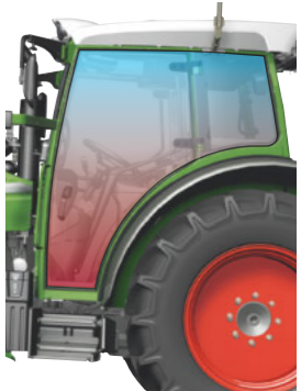
□ Ideal für Einsätze im Winterdienst ist die optional erhältliche Fußbodenheizung. Zusammen mit einer Steuerung über Temperatursensoren wird eine effiziente sowie schnelle Erwärmung des Fußraumes erreicht.
