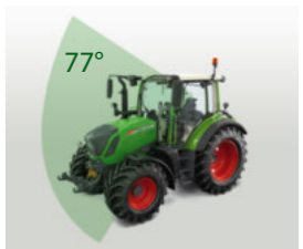
■ Bei der VisioPlus-Kabine wurde der Blickwinkel im Vergleich nach oben verdreifacht auf 77°. Auch nach unten wurden die Sichtlinien optimiert und der Radeinlauf ist sehr gut einsehbar.
