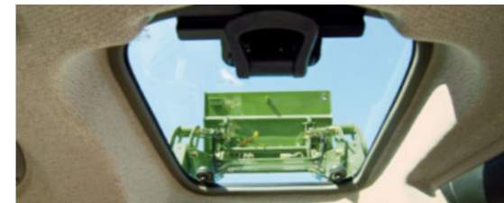
■ Für beste Sicht nach oben verfügt der 200 Vario serienmäßig über ein Dachfenster. Zur zusätzlichen Belüftung der Kabine kann das Dachfenster nach oben geöffnet werden. Vor intensiver Sonneneinstrahlung schützt das ausziehbare Sonnenrollo.
