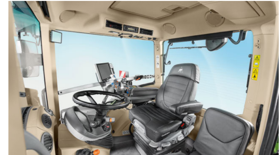
■ Die x5-Kabine der Großtraktoren bietet entsprechend großzügige Platzverhältnisse und durch die großen Glasflächen eine hervorragende Sicht. Sitz, Lenkrad und Armlehne können individuell eingestellt werden, so dass jeder Fahrer eine ergonomische Position findet.
