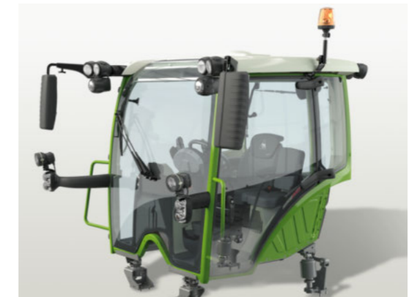
■ Für alle Baureihen bietet Fendt ein ausgefeiltes Federungskonzept an. Mit einer Kabinenfederung können die Serien Fendt 200 und 300 Vario auf Wunsch ausgestattet werden, ab der Serie 500 Vario ist die Kabinenfederung Standard. Im Bild: Die auf vier Punkten gelagerte, pneumatische Komfort-Kabinenfederung mit integrierter Niveauregelung reduziert Schwingungen auf ein Minimum.
