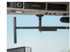
□ Für zusätzliche externe Terminals gibt es optional eine verstellbare Terminalhalterung in der VisioPlus-Kabine.
