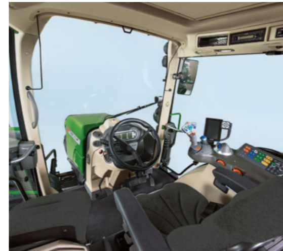
■ Die Baureihen 300, 500 und 700 Vario sind mit der VisioPlus-Kabine ausgestattet, welche sich durch perfekte Sichtlinien und ein ausgezeichnetes Raumgefühl mit 6,1 m 2 Glasfläche auszeichnen.
