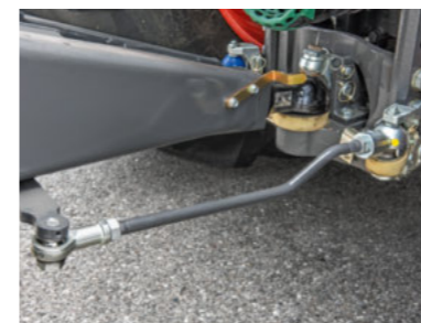
Optional sind sie auch mit einer hydraulischen oder elektronischen Zwangslenkung erhältlich.
