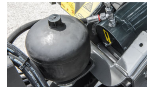
Die Deichselfederung des Fendt Tigo sorgt für noch mehr Fahrkomfort.
