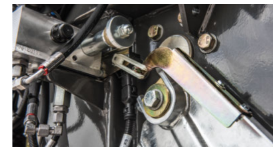
Die Knickdeichsel-Lageregelung sorgt dafür, dass der eingestellte Öffnungswinkel der Pick-Up automatisch gehalten und geregelt wird. Das garantiert einen gleichbleibenden und konstanten Gutfluss ohne Verengungen und eine saubere Recharbeit auch in kuppertem Gelände.
