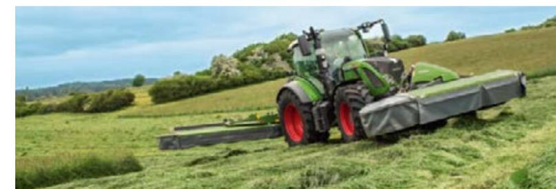
Für schnelle und sichere Wendemanöver am Vorgewende herrscht ausreichend Bodenfreiheit und der Kompensationszylinder am Auslegearm hält das Mähwerk am Vorgewende stabil.
