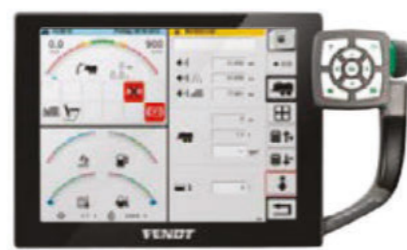
Die Ertragsmessung erfasst neben der bearbeiteten Fläche in ha die geerntete Frischmasse und die Durchsatzleistung.
