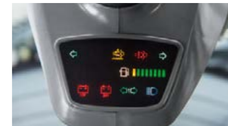
Die zentralen Kontrollleuchten an der Lenksäule geben Auskunft über die wichtigsten Fahrparameter.
