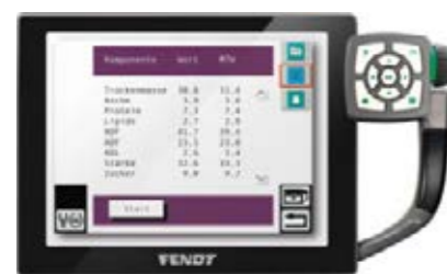
Beispielhafte Visualisierung eines ISOBUS-fähigen NIR-Sensors mittels Variotronic Gerätesteuerung.
