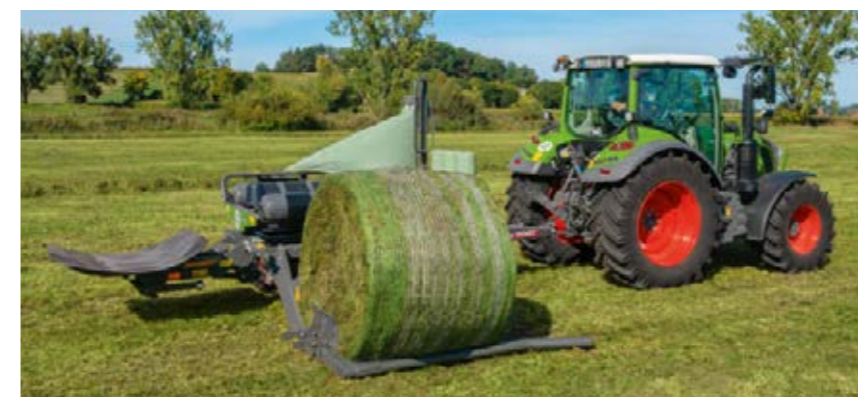
Sowohl der Ladearm als auch der Wickeltisch lassen sich an unterschiedliche Ballengrößen anpassen. Ballen mit einem Durchmesser von 1,25 m bis 1,6 m können sicher aufgenommen und luftdicht in Folie verpackt werden.
