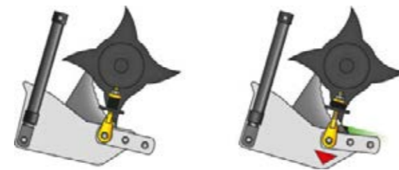
Das Entlastungssystem FlexControl verhindert Blockaden zuverlässig.
