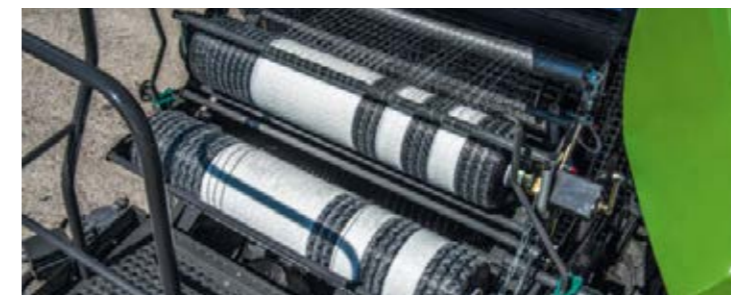
Mit dem EasyLoadSystem gelingt das Nachlegen von Netzrollen innerhalb kürzester Zeit.
