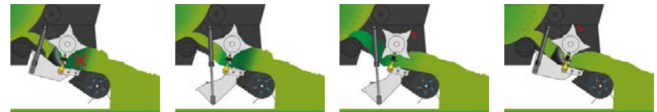
Im Fall einer Verstopfung wird der hintere Teil des Schneidbodens um 500 mm abgesenkt.
