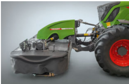
Unterschiedliche Anbauböcke für Mäherwerke mit/ohne Aufbereiter.
