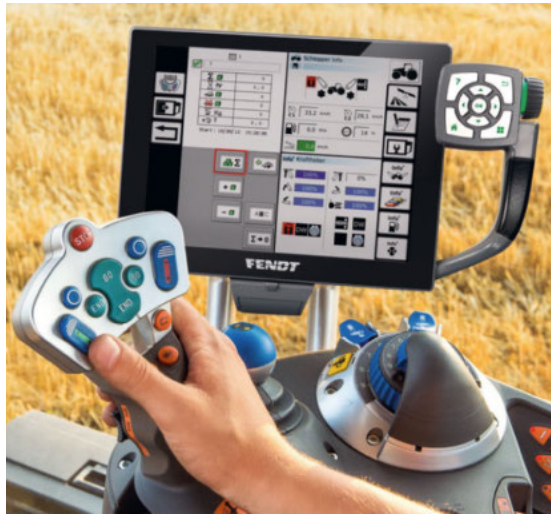
Startklar mit ISOBUS: Alle Fendt Quaderballenpressen sind serienmäßig ISOBUS-fähig. Damit kann die Presse auch direkt über das Varioterminal oder über ein Terminal eines ISOBUS-fähigen Traktors bedient werden.
